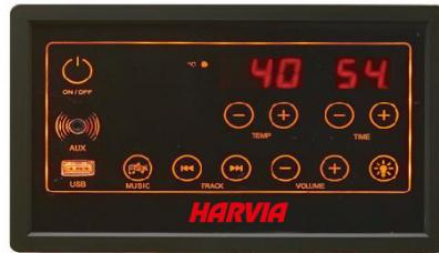
Drücken Sie auf **Ein/Aus**, um die Steuerung einzuschalten. Die Heizelemente beginnen zu heizen. Es wird die Kabinentemperatur und die Laufzeit angezeigt. Die Laufzeit wird automatisch auf 60 Minuten oder auf die zuletzt gewählte Zeit aktiviert. Wenn Sie erneut auf **Ein/Aus** drücken, werden alle Funktionen (Heizelemente, Licht und Musik) ausgeschaltet.
