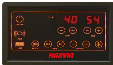
Käynnistä ohjain painamalla **pääälle/pois**-symbolia. Lämmitysvastukset aloittavat lämmityksen. Saunan lämpötila ja lämmityksen toiminta-aika ovat näytössä. Lämmityksen toiminta-aika on automaattisesti 60 minuuttia tai viimeksi valitun toiminta-ajan mukainen. Mikäli painat uudelleen **pääälle/pois**-symbolia, kaikki toiminnot (lämmityselementit, valaistus ja musiikki) kytkeytyvät pois päältä.
