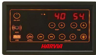
Нажмите **вкл./выкл.**, чтобы включить управление. Нагревательные элементы начинают нагреваться. Он покажет температуру в кабине и время работы. Время выполнения автоматически активируется до 60 минут или до последнего выбранного времени. Если вы снова нажмете **вкл./выкл.**, все функции (нагревательные элементы, свет и музыка) будут отключены.
